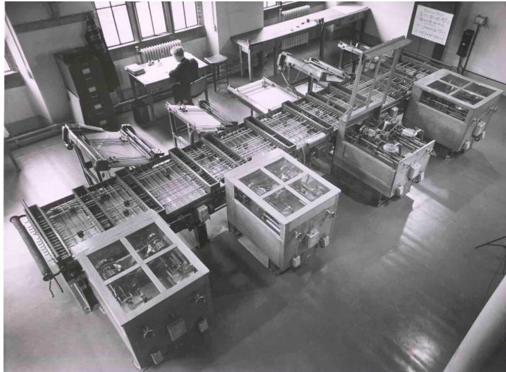
One of the MIT Differential Analyser
